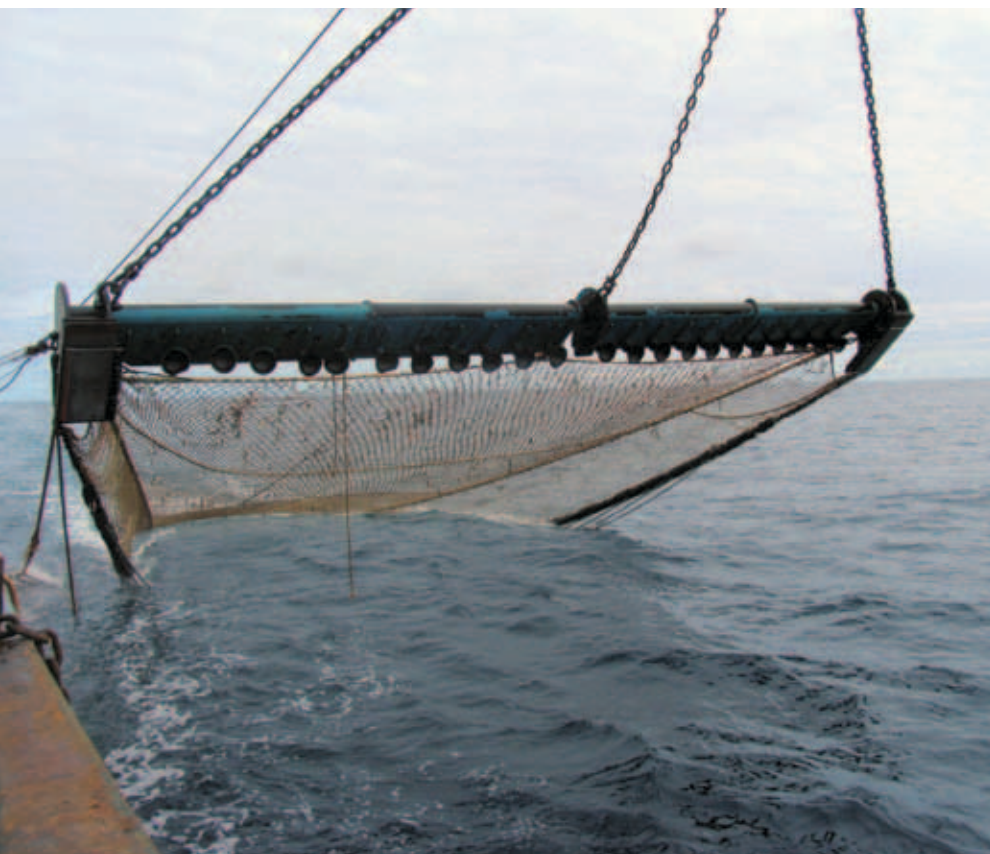
De balkoppen op de boom zorgen voor turbulentie op de zeebodem. Vis wordt de bodem uitgejaagd met waterstroom in plaats van de conventionele wekkerketting.
