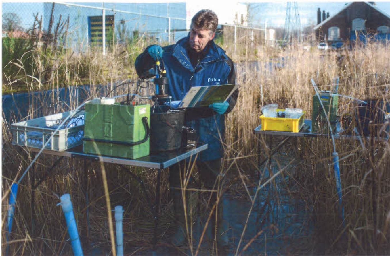
FIGUUR 2: DELTARESMEDEWERKER ANDRÉ CINJEE DOET METINGEN IN EEN BEVROREN RIETVELD; OP DE ACHTERGROND EEN WINDMOLEN WAARMEE VERONTREINIGD GRONDWATER WORDT OPGEPOMPT. EEN HELOFYTENFILTER KAN OOK IN DE WINTER VERGRIJSD GRONDWATER ZUIVEREN. FOTO: DELTARES/WELMOED JILDERDA.
